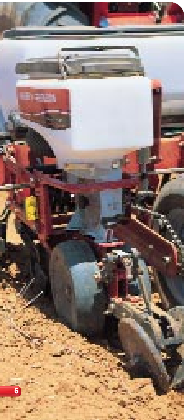
„Sétáló gerendelyen” elhelyezett talajkövető kerekek
